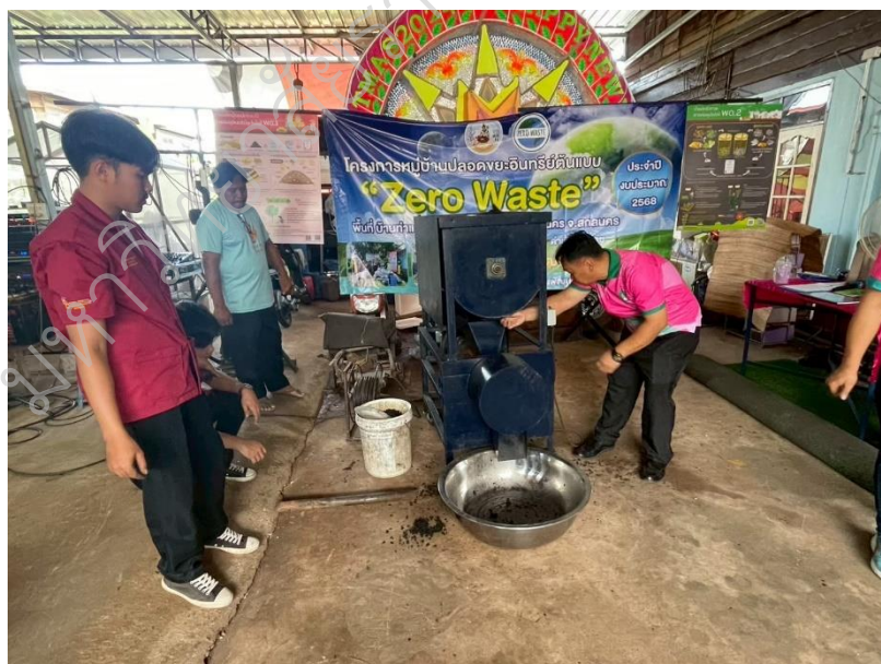
ภาพประกอบ ฅ-4 เปิดเครื่องผสม ผสมส่วนผสมของปุ๋ยอินทรีย์ให้เข้ากัน
