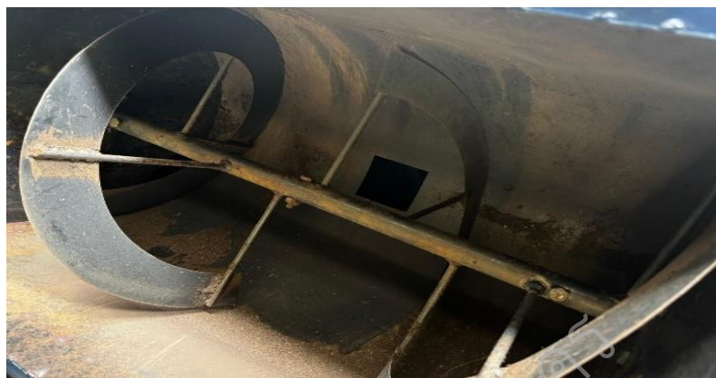
ภาพประกอบ ช-11 ทำความสะอาดและเอาเศษดินปลูกรอบออกจากตัวเครื่อง
