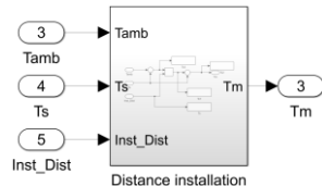
รูปที่ 6 แบบจำลองย่อยระยะทางการติดตั้งและอุณหภูมิหลังคา
