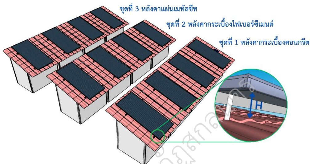
ภาพประกอบ 2 ชุดทดสอบประสิทธิภาพแผงโซลาร์เซลล์
