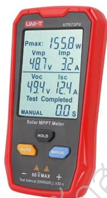
ภาพประกอบ 14 เครื่องมือวัดพลังงานแสงอาทิตย์ MPPT ยี่ห้อ UNI-T
