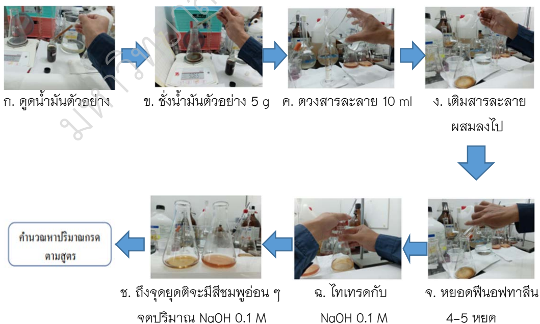
ภาพประกอบ 42 การหาค่าความเป็นกรดของน้ำมันเชื้อเพลิง
