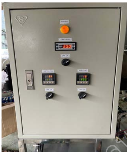
ภาพประกอบ 58 เช็คอุณหภูมิทั้งสามตัวควบคุม
