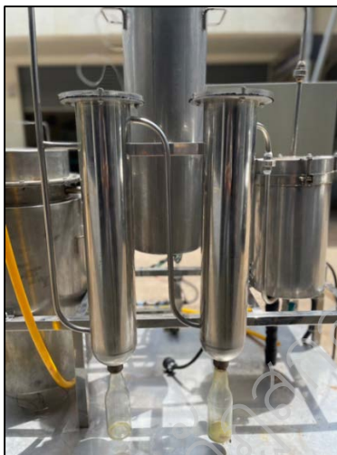
ภาพประกอบ 20 การผลิตน้ำมันเชื้อเพลิงจากเศษชีอย่างพาราด้วยการไพโรไลซิส
