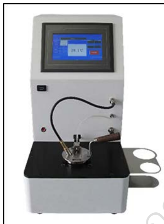
ภาพประกอบ 40 การหาค่าจุดวาบไฟและจุดติดไฟของน้ำมันเชื้อเพลิง
