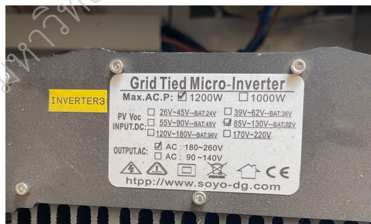
ภาพประกอบ 19 สเปคของอินเวอร์เตอร์ที่อยู่ในรถรางไฟฟ้า มหาวิทยาลัยราชภัฏสกลนคร ขนาด 1.2 KW ต่อ 1 เฟส
