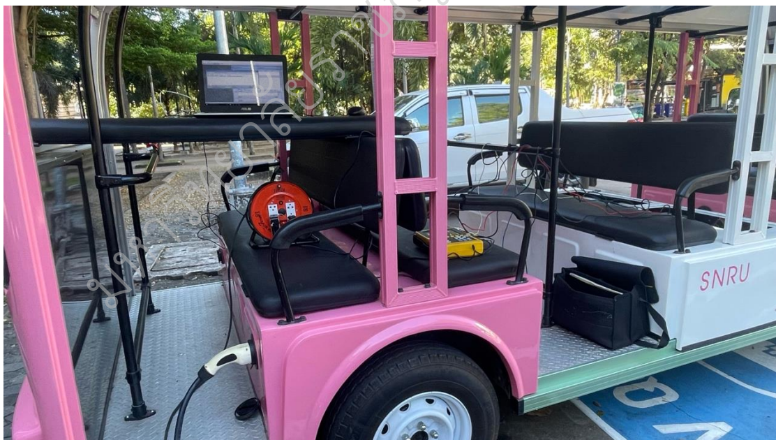
ภาพประกอบ 43 ภาพการใช้เครื่องมือวิเคราะห์ไฟฟ้าเพื่อทำการวัด ค่าพลังงานไฟฟ้า ของรถรางไฟฟ้า มหาวิทยาลัยราชภัฏสกลนคร
