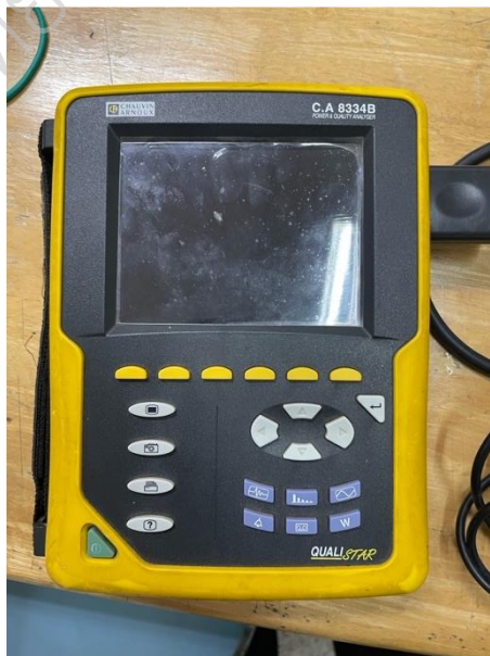
ภาพประกอบ 21 เครื่องมือวัดที่ใช้ในการทำวิจัยยี่ห้อ CHAUVIN ARNOUX รุ่น C.A 8334B
