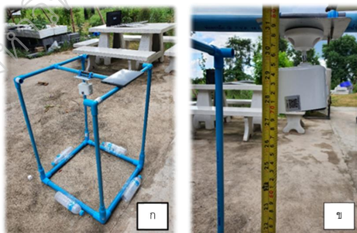
ภาพประกอบ 34 แพให้อาหารปลาและแท่นยึดกล้อง แพพร้อมแท่นยึด (ก), ระดับความสูงกล้องจากผิวน้ำ (ข)
