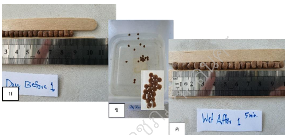
ภาพประกอบ 31 หาเส้นผ่านศูนย์กลางอาหารเม็ด อาหารเม็ดก่อนลอยน้ำ (ก) อาหารเม็ดลอยน้ำ (ข) อาหารเม็ดหลังลอยน้ำ (ค)
