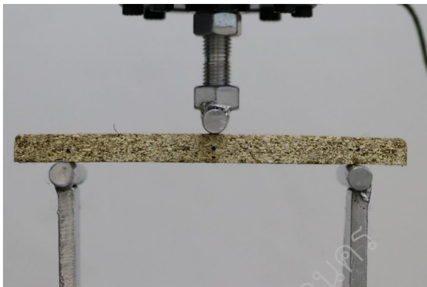
ภาพประกอบ 20 การทดสอบความต้านแรงดัดและมอดุลัสยืดหยุ่น
