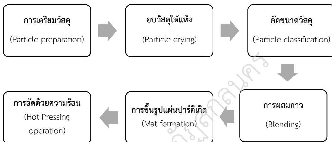
ภาพประกอบ 6 แผนผังแสดงขั้นตอนการทำแผ่นไม้ปาร์ติเกิล
