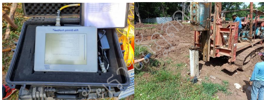
ภาพประกอบ 3 ภาพแสดงเครื่องมือ การติดตั้งที่ใช้ในการทดสอบโดยวิธีพลศาสตร์
