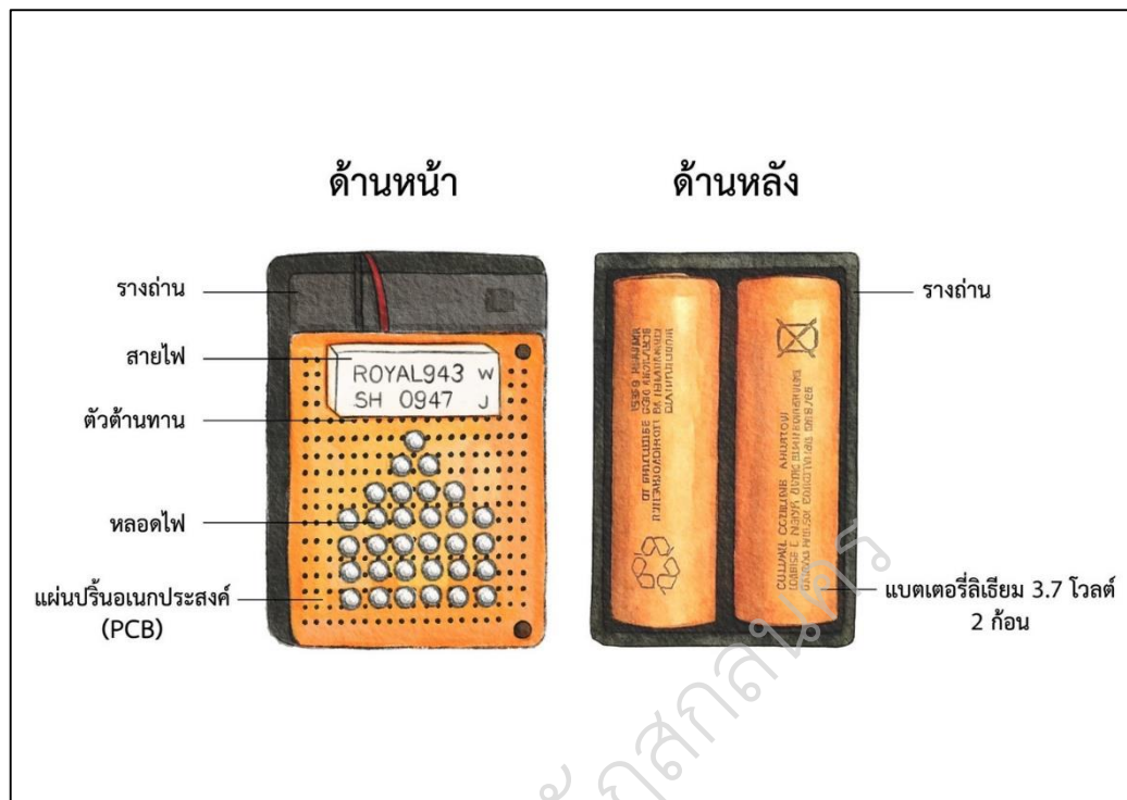
ภาพประกอบ 13 ตัวอย่างที่นักเรียนออกแบบการสร้างไฟฉายจากหลอด LED
