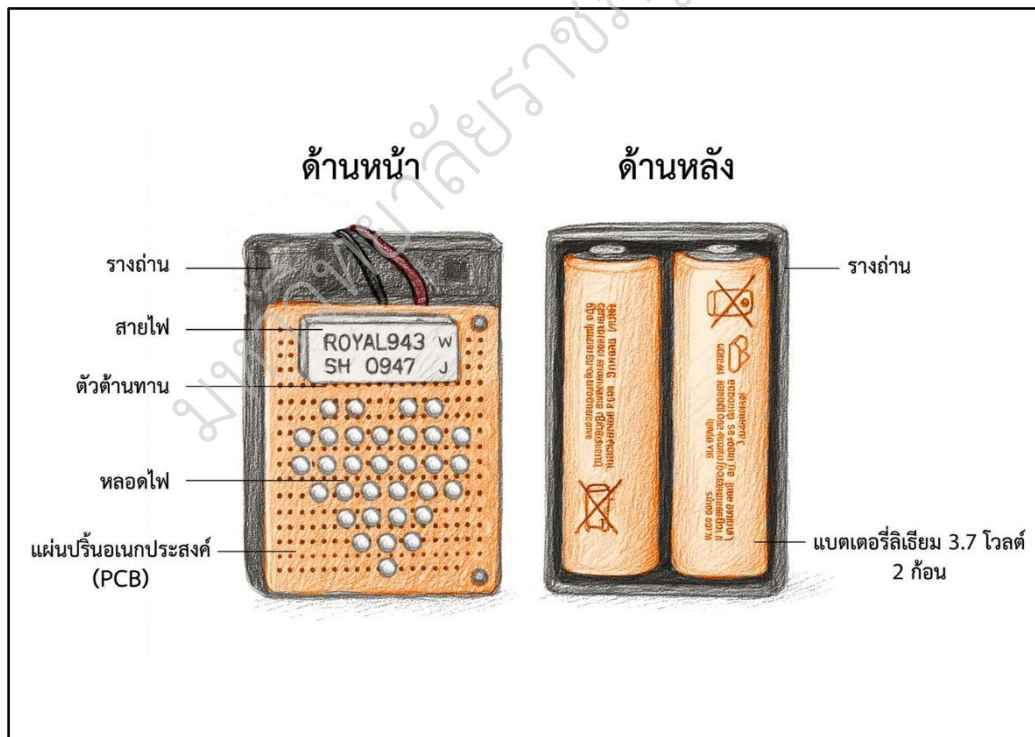
ภาพประกอบ 12 ตัวอย่างที่นักเรียนออกแบบการสร้างไฟฉายจากหลอด LED
