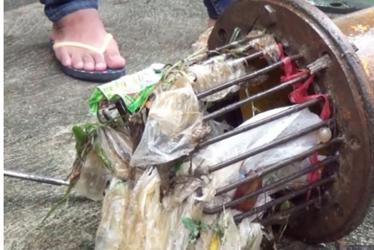
เมืองคอนขยะอุดทอระบายน้ำ กรมชลประทานเร่งสูบน้ำออก
